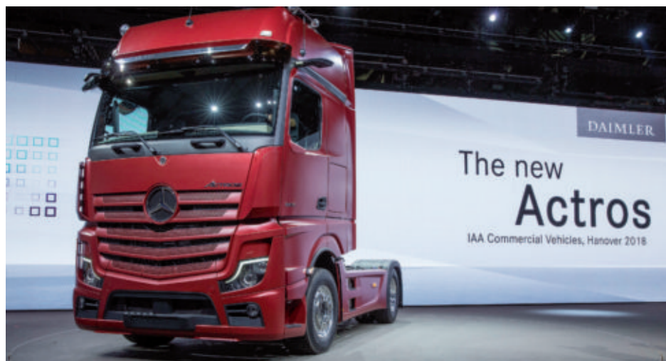
Novo Actros da Mercedes-Benz: câmaras no lugar de espelhos reduzem o arrasto
