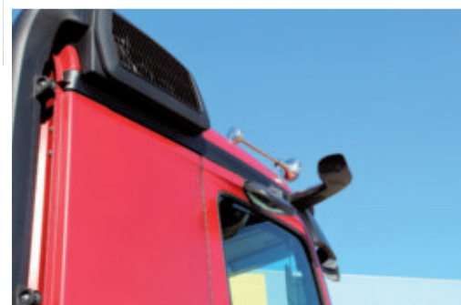
Novo Actros da Mercedes-Benz: câmaras no lugar de espelhos reduzem o arrasto
