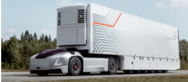
Volvo Vera: caminhão autônomo de acionamento elétrico que dispensa a cabine
